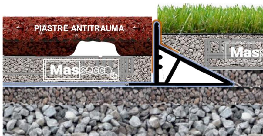
Performance: La pavimentazione è molto più stabile nel tempo (non si formano sconnessioni tra le piastre) e la struttura aperta del MASsecco® garantisce il drenaggio nonché il ricircolo dell'aria preservando un ambiente più sano e confortevole.
